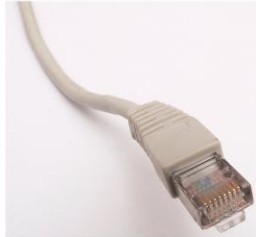
Un connecteur Ethernet standard RJ-45
