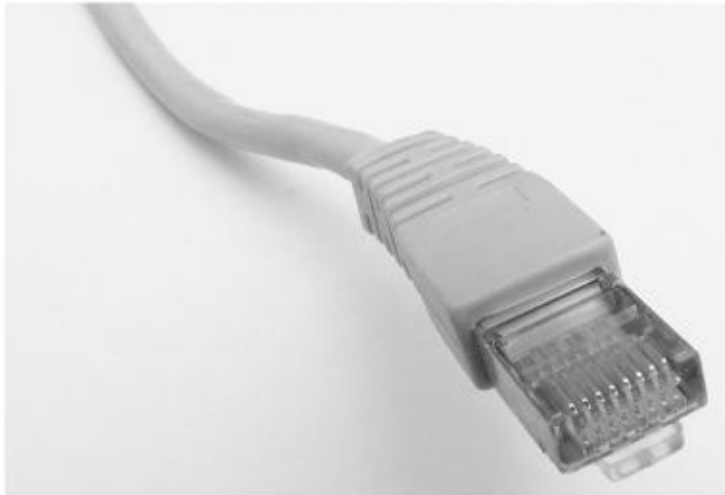
Un connettore Ethernet RJ-45 standard
