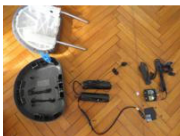
1 : unité de contrôle ; 2 : batteries ; 2 : les deux batteries du dispositif 3 : antenne GPS ; 4 : microphone ; d'écoute ; 4 : les micros connectés 5 : carte SIM au dispositif d'écoute ; 6 : dispositif 7 : carte SD d'écoute démonté ; 7 : carte SD
