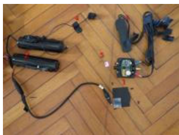
1 : unité de contrôle ; 2 : batteries ; 2 : les deux batteries du dispositif 3 : antenne GPS ; 4 : microphone ; d'écoute ; 4 : les micros connectés 5 : carte SIM au dispositif d'écoute ; 6 : dispositif 7 : carte SD d'écoute démonté ; 7 : carte SD
