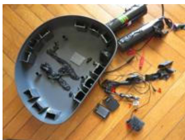
1 : unité de contrôle ; 2 : batteries ; 2 : les deux batteries du dispositif 3 : antenne GPS ; 4 : microphone ; d'écoute ; 4 : les micros connectés 5 : carte SIM au dispositif d'écoute ; 6 : dispositif 7 : carte SD d'écoute démonté ; 7 : carte SD
