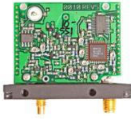
Module permettant la transmission par ondes radio
