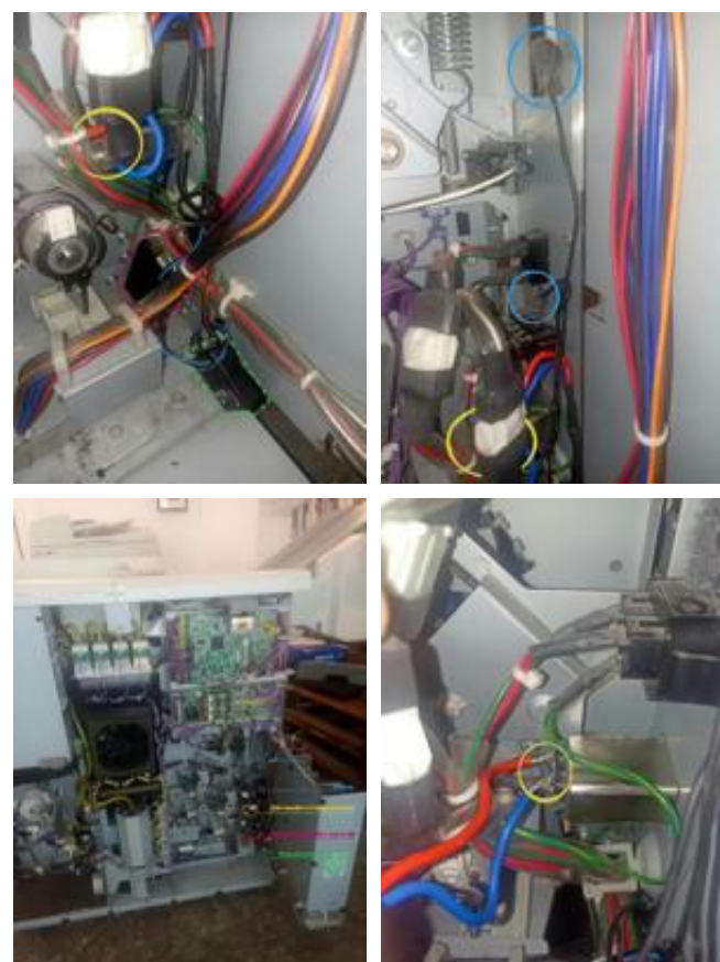
Bleu: micros; Jaune: fils soudés à l'alimentation; Rose: boîtier carte SIM + carte SD; Vert: transformateur
