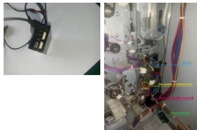
Bleu: micros; Jaune: fils soudés à l'alimentation; Rose: boîtier carte SIM + carte SD; Vert: transformateur
