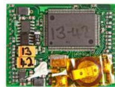
Module fournissant le signal GPS (autre côté)
