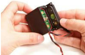
Côté du module d'émission-réception
