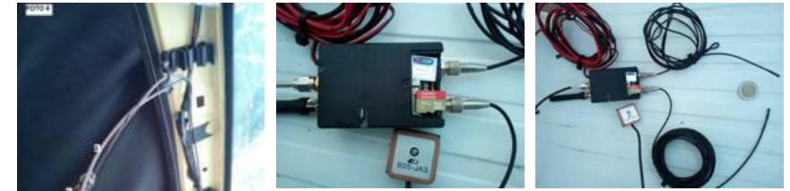
L'intérieur du machin avec antenne et cartes (en bas, avec contour marron, le GPS)
