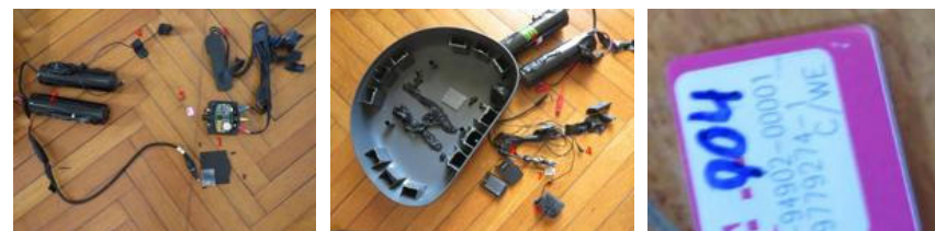
1: unité de contrôle ; 2: les deux batteries du dispositif d'écoute ; 3: antenne GPS ; 4: microphone ; 5: micros connectés au dispositif d'écoute ; 6: dispositif d'écoute démonté ; 7: carte SD
