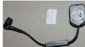
Antenne GPS et carte SIM
