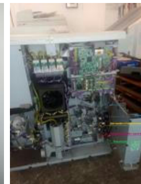
Bleu: micros; Jaune: fils soudés à l'alimentation; Rose: boîtier carte SIM + carte SD; Vert: transformateur
