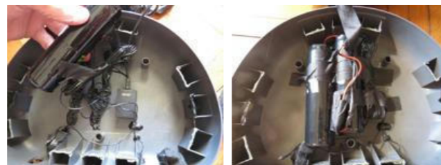
1: unité de contrôle ; 2: batteries ; 3: antenne GPS ; 4: dispositif d'écoute ; 5: les micros connectés au dispositif d'écoute ; 6: dispositif d'écoute démonté ; 7: carte SD
