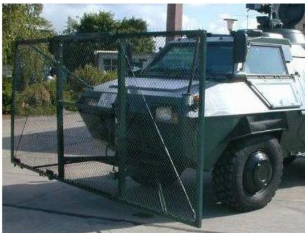
SW4 mit sogenanntem „Räumgitter“.
