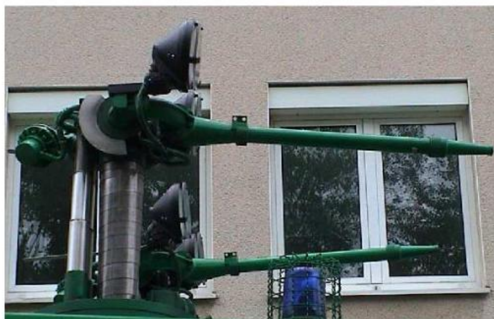
Die beiden Dachwerfer des WaWe 9000.
