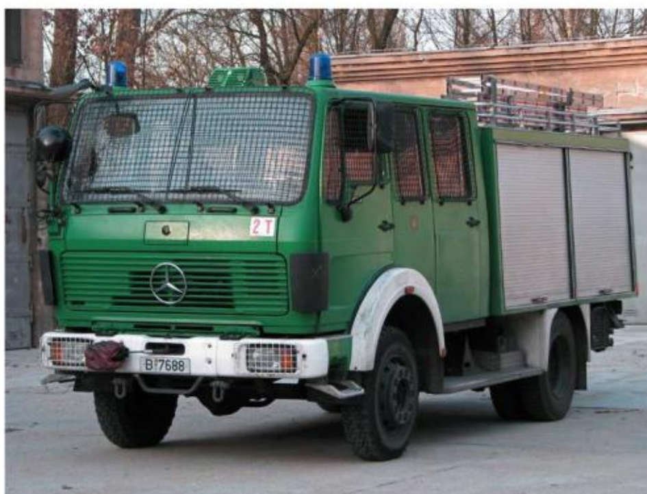
Die maximal 9 Beamt_innen in der Kabine sind durch Vergitterung 1 vor den Fahrzeugscheiben gegen Steinwürfe geschützt.
