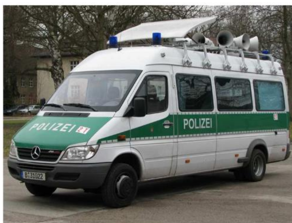
ist gegen Durchstechen der Fahrzeughülle mit einem Durchstichschutz (S.100) aus Polycarbonat versehen. Sollte aus den Reifen die Luft entweichen, verfügen sie über Notlaufeigenschaften (S.102).
